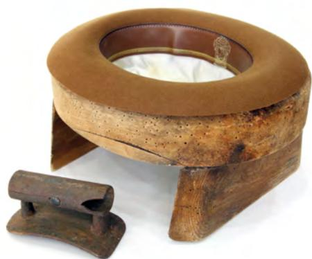
**Figura 28.** Molde com pés e ferro para dar forma à aba do chapéu (M. Ribeiro/MMPNF).
