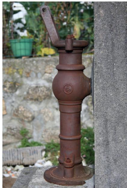
**Figura 3** Exemplar de bomba de picota metálica.
