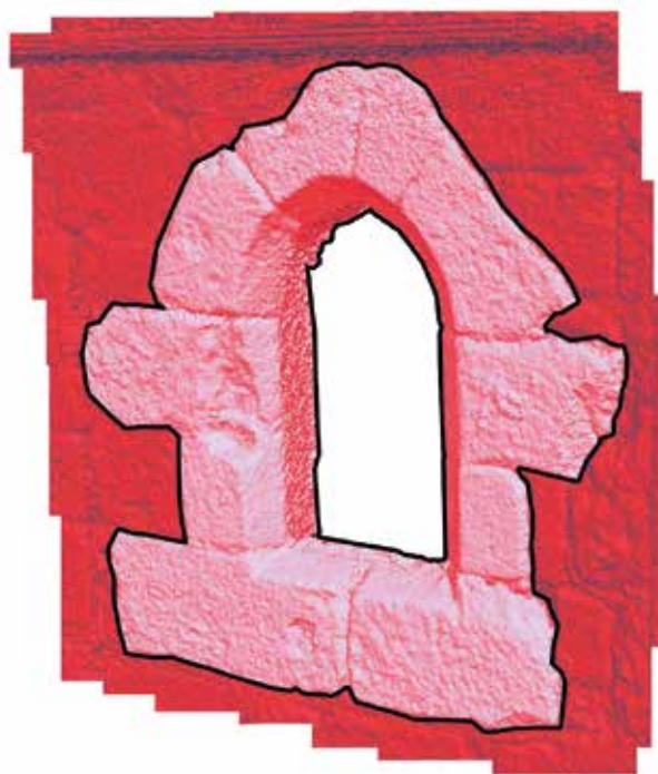
Figura 6. Modelo fotogramétrico da janela medieval do piso n.º 2.
