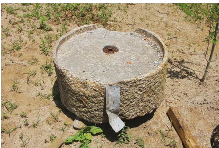
FIGURA 86. Aspeto da mó dormente aquando da sua remoção do interior do moinho.
