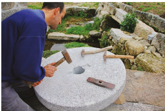
FIGURAS 93 E 94. Trabalhos de colocação da segurelha na nova mó andadeira.
