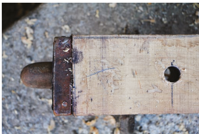
FIGURAS 131 E 132. Abertura de orifício na pela para suporte do novo rodízio.
