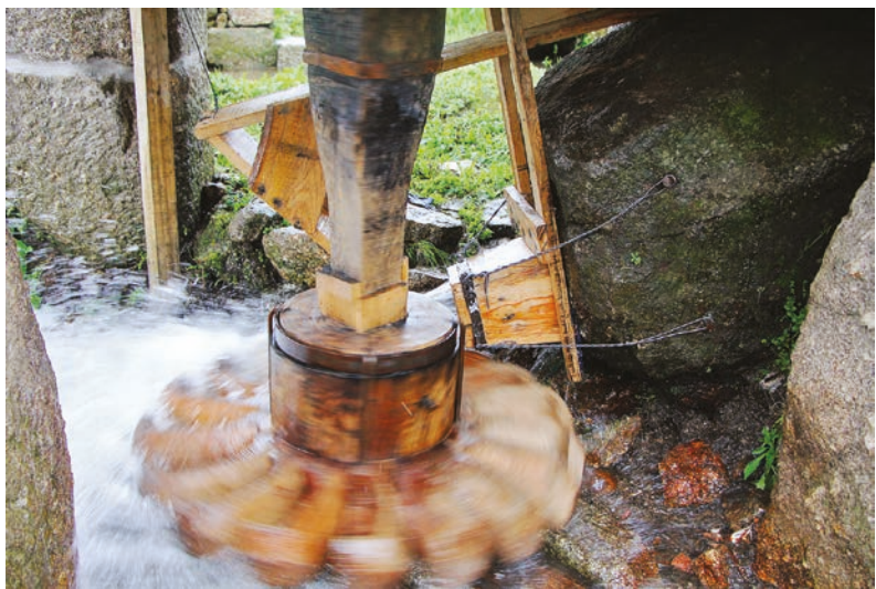
FIGURAS 152 E 153. Processo de teste do novo mecanismo de moagem do moinho.
