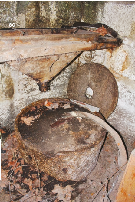
FIGURAS 80 E 81. Pormenor do mecanismo de moagem no início dos trabalhos.
