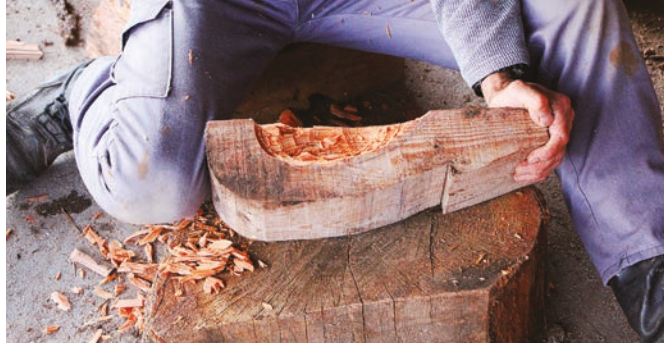
FIGURA 134. Produção das penas para o novo rodízio.
