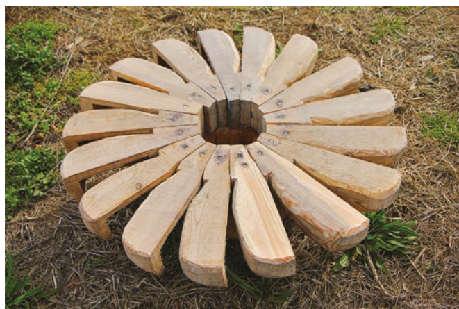
FIGURA 136. Fixação das penas no novo rodízio.
