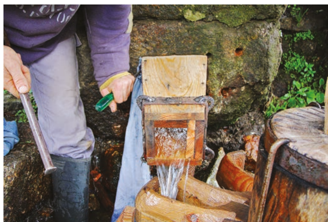
FIGURA 146. Isolamento das juntas na zona de encaixe entre a seteira e o cubo.
