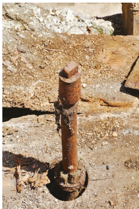
FIGURA 85. Pormenor do veio do mecanismo motor do moinho.
