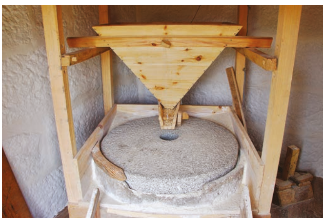
FIGURAS 105 E 106. Aspeto do novo mecanismo de moagem do moinho.
