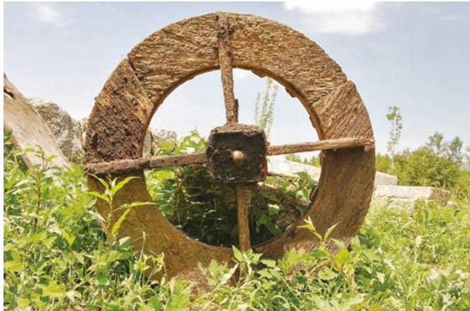
FIGURAS 116 E 117. Aspeto do rodízio do moinho após a sua remoção.
