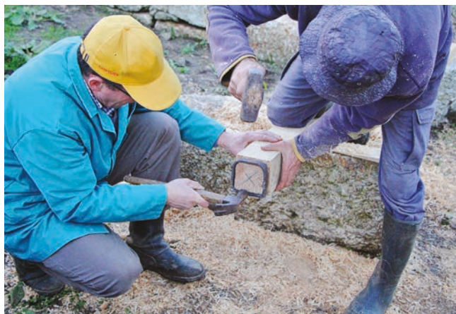
FIGURA 128. Colocação de argola metálica na base da pela.
