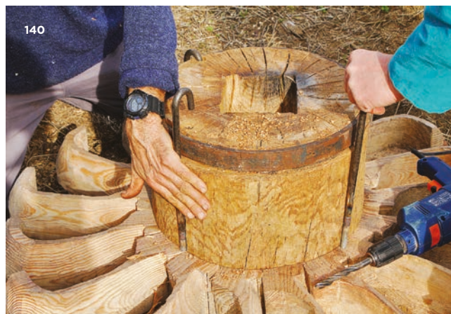
FIGURAS 137 A 140. Aplicação, na base do penado, de um aro metálico perfurado (Figuras 137 e 138) e trabalhos de fixação do penado ao tambor (Figuras 139 e 140).
