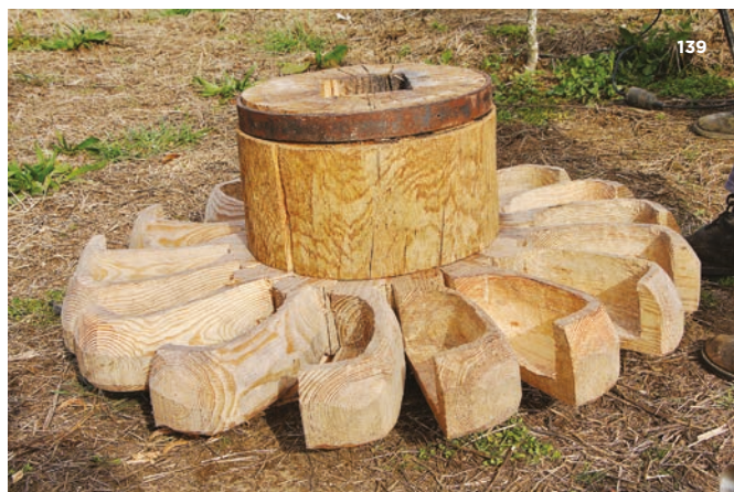
FIGURAS 137 A 140. Aplicação, na base do penado, de um aro metálico perfurado (Figuras 137 e 138) e trabalhos de fixação do penado ao tambor (Figuras 139 e 140).
