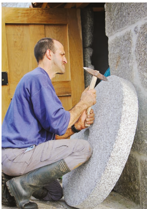
FIGURAS 93 E 94. Trabalhos de colocação da segurelha na nova mó andadeira.
