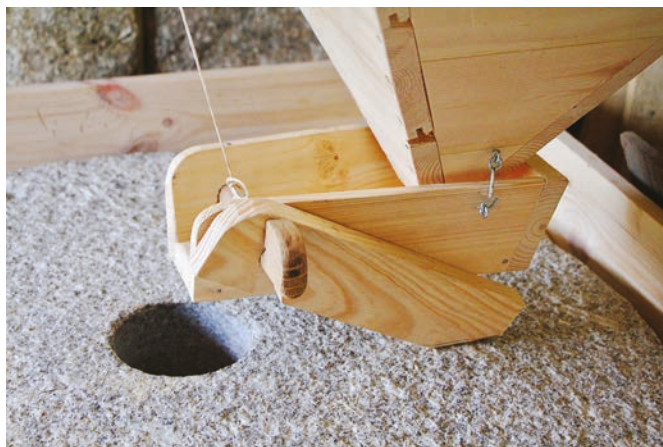
FIGURA 104. Pormenor da nova chamadeira.
