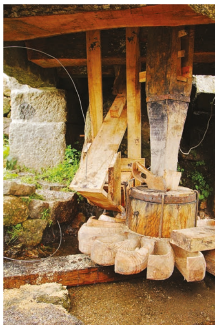
FIGURAS 149 E 150. Aspeto dos trabalhos de instalação do pejadouro.
