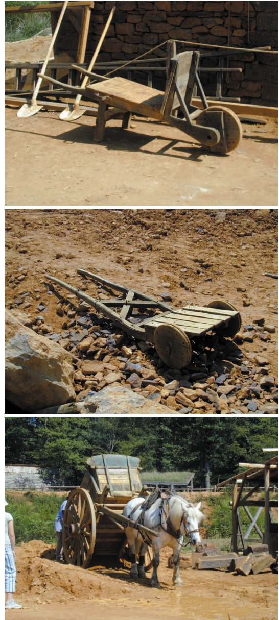
Figura 24. Carros de tracção humana e animal empregues no transporte de pedra, a partir do projecto de Arqueologia Experimental "Chantier Médiéval de Guédelon", Treigny, França (2004).
