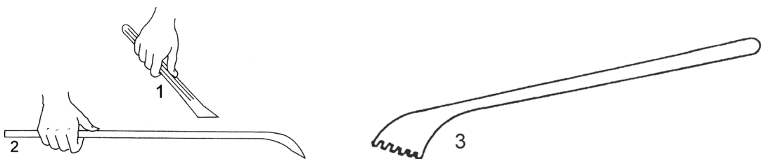
Figura 16. Exemplos de raspadores; 1 – cinzel plano que funciona como raspador; 2 – raspador medieval (alavanca) 3 – raspador dentado (Rockwell, 1993; Bessac, 1985).
