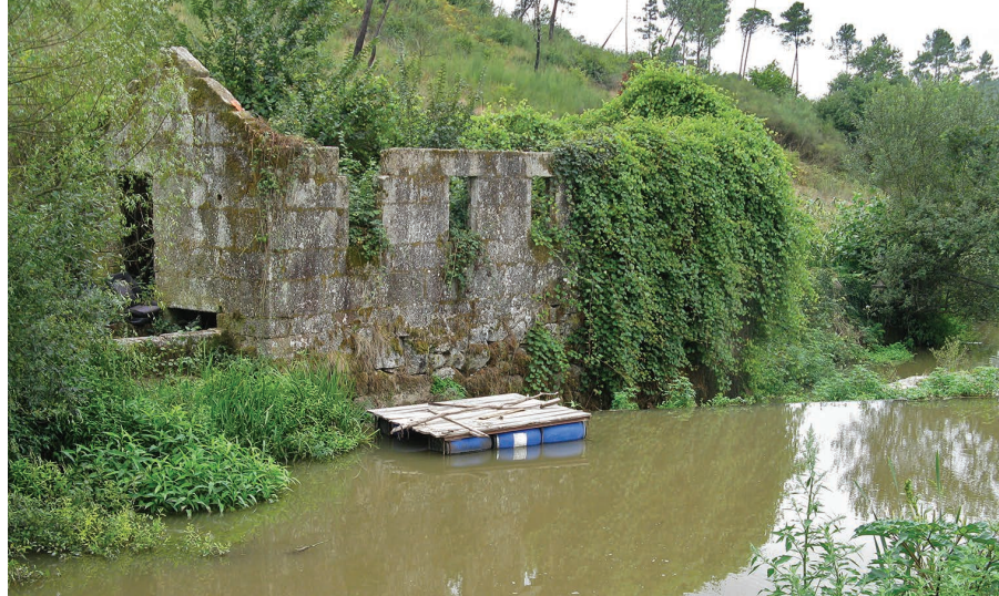
▲ FIGURA 25. Engenho de serração de Pias (Moinho do Engenho, n.º 57), que, além do sistema de serração de madeira, integrava, igualmente, um moinho de rodízio acionado por uma caleira em pedra (granito), com cobertura.
