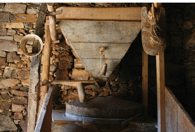
FIGURA 35. Exemplo do bom estado de conservação dos diversos elementos que integram o sistema de moagem do Moinho de São Miguel 4 (n.º 191).
