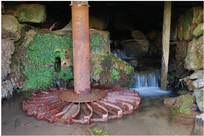
FIGURA 34. Rodízio metálico, com sistema de penas (Moinho da Casa de Porto 1, n.º 167).
